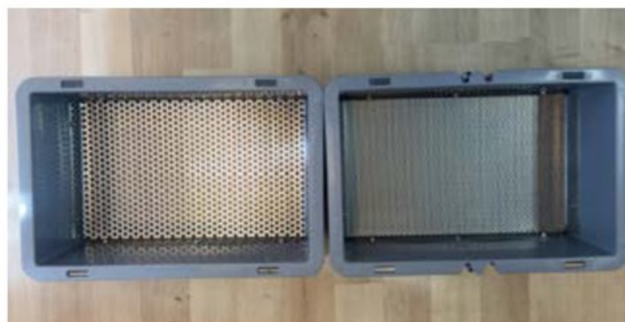
Bilde 1. En fibertest utføres ved å vaske gjødsel gjennom siler med ulik porestørrelse.
