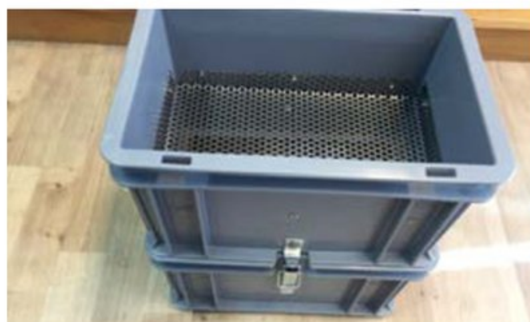
Bilde 1. En fibertest utføres ved å vaske gjødsel gjennom siler med ulik porestørrelse.
